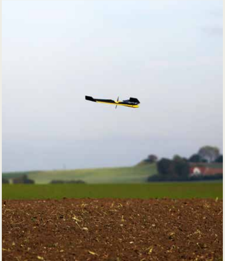
Skel.dk's drone vejer 675 gram og kan levere data, der kan omsættes til både kort og 3D-modeller. Foto: Skel.dk
